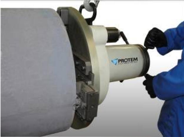
La machine à chanfreiner portable modèle US 150-24" est conçue pour le chanfreinage, le dressage, le délardage, le dérabage, la mise à longueur de pipes et tubes de Ø150 mm intérieur à Ø 610 mm extérieur.
